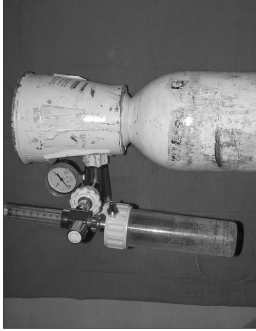
Fig 2 : bouteille d'oxygène avec manodétenteur
