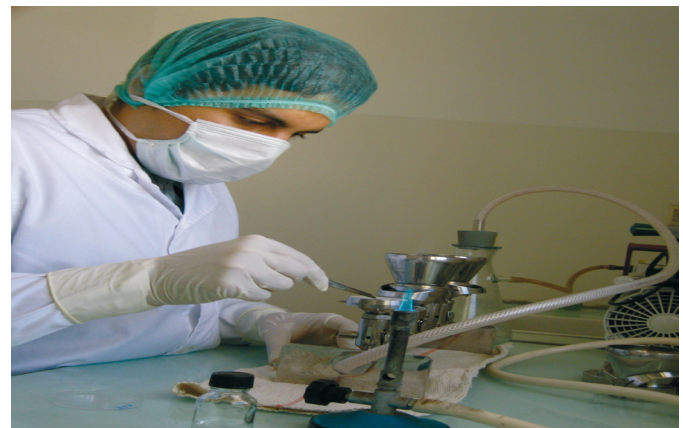
Figure 2 : essai de stérilité par filtration sur membrane
