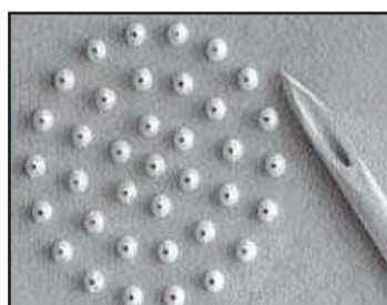
Figure 6 : Image microscopique d'une série de microaiguilles et d'une aiguille hypodermique régulière
